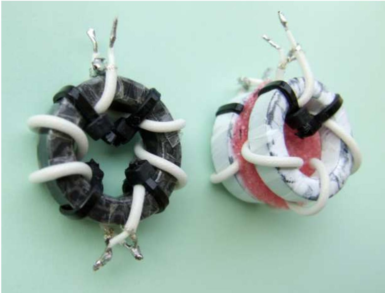
**Bild 5:** Balun 4:1 ( $50 \Omega : 12,5 \Omega$ ) auf einem und auf zwei Ferritringen FT114-61 für 10 – 160 MHz
