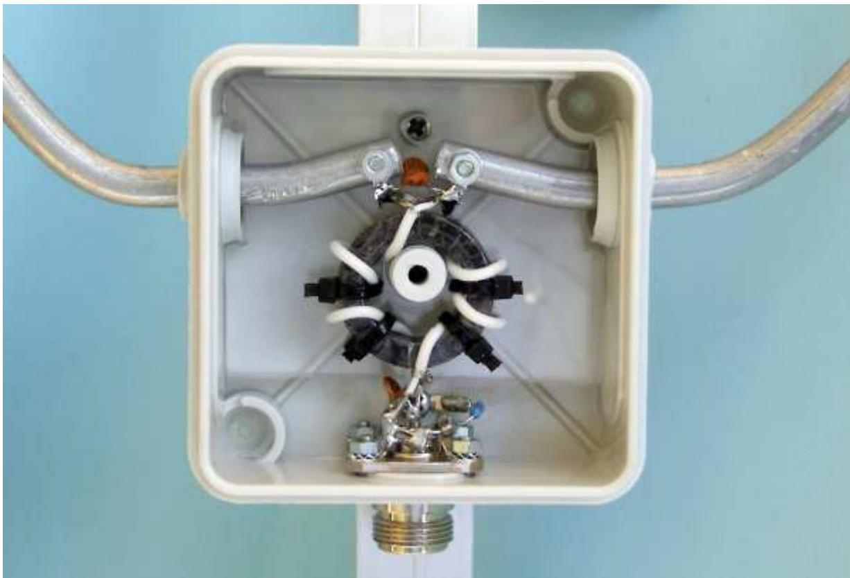
**Bild 6:** Blick in die Antennendose mit kompensierten Balun
