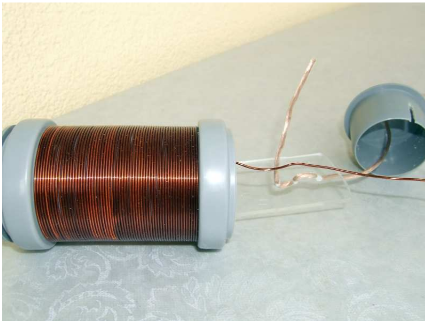
Abb.4: Eine der Spulen für die DO-Antennen. Gut zu erkennen sind die Spulen-Windungen, die Zugentlastung (durch- sichtig) und der Deckel mit Schlitz. Die Drähte von Antenne und Spule sind noch nicht gekürzt und noch nicht miteinander verbunden.
