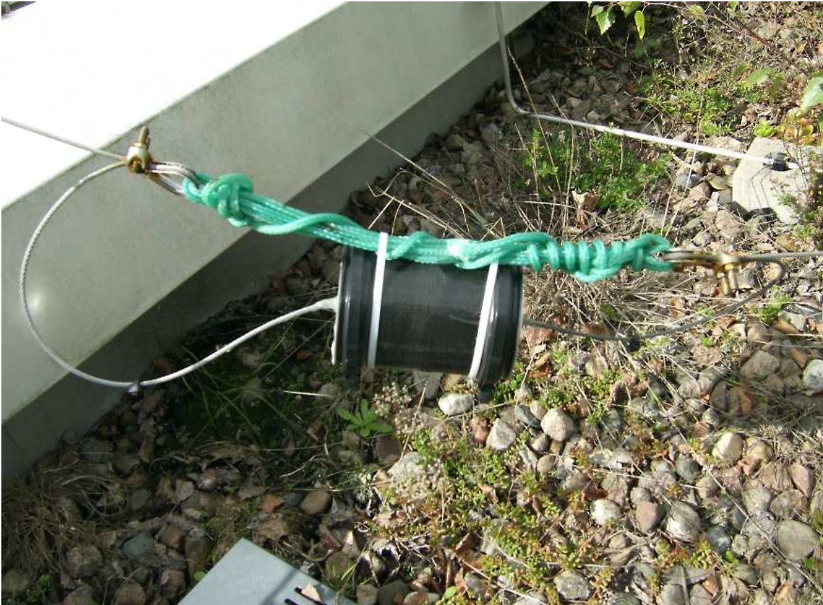
Abb.11: Mögliche Befestigung der Spule ohne innere Zugentlastung (siehe Text). Das grüne fünffache Verbindungsseil zwischen den beiden Seilkauschen ist aber hier etwas überdimensioniert.
